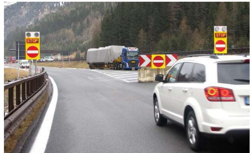
IL RAV È UN SISTEMA IN GRADO DI RILEVARE L'ALTEZZA DEI VEICOLI IN TRANSITO MEDIANTE UN SOLO SENSORE INSTALLATO A LATO STRADA.
