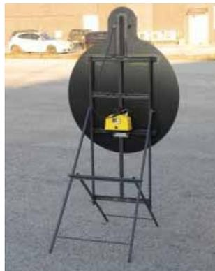
Realizzato in materiale VTR disco Ø 90 cm., rifrangenza cl.2 prismatica, con lampada multiled 100 omologata cl. L2H e certificata “CE” o led M200 omologata cl. L8H e certificata “CE” a luce lampeggiante gialla, completo di cavalletto e pacco batterie (batterie escluse).
