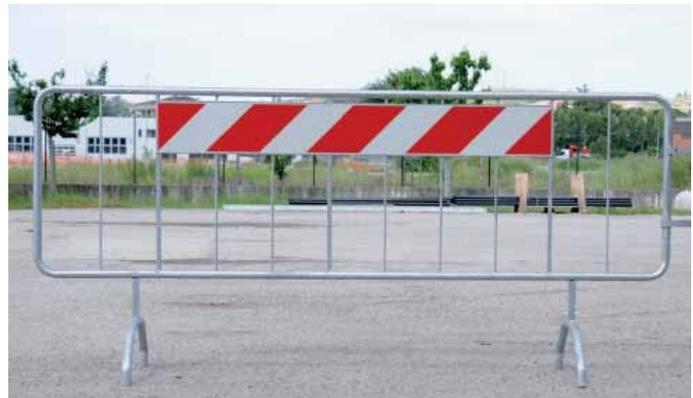
Fig. 2402 dimensioni 110x200 cm., tubolare  $\varnothing$  32 mm., con nr. 6 tondini  $\varnothing$  8 mm., nr. 3 tubolari quadri 15x15 mm., applicato pannello rifrangente b/r cl.1 20x150 cm.
