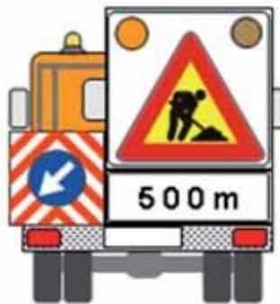
Esempi di presegnalazione di cantiere mobile in corsia di emergenza, il pannello segnaletico con appendice distanziometrica deve in ogni caso contenere un triangolo “lavori in corso” con lato 120 cm. e, nel caso dell’autocarro, essere integrato con lampade led M200 gialle omologate cl. L8H e certificcate “CE” ad elevata efficienza.
