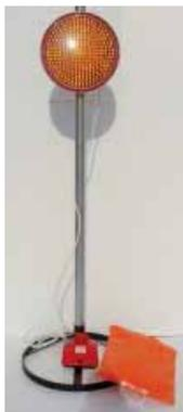
Lampada led ad alta efficienza multiled 300 gialla omologata cl. L9M, alimentato con batterie 12V. 180Ah da utilizzare singolo sul lato dx (cantieri di breve durata o rimovibili) o su entrambi i lati anche in più sequenza (cantieri di lunga durata).
