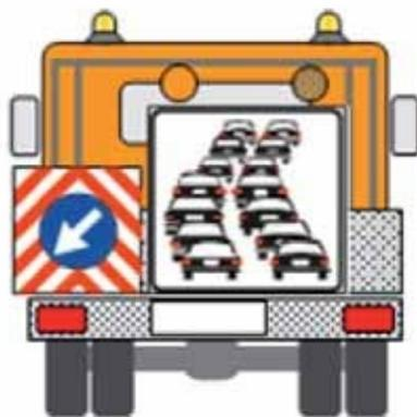
Esempio di cartello e autocarro utilizzabili per la presegnalazione di code o rallentamenti (in alternativa al mezzo dotato di PMV full color). Il pannello “code” deve avere dimensioni non inferiori a 90x90 cm. e il cartello Fig. II 398 Art. 38 (90x90) sul carrellino, va obbligatoriamente applicato contestualmente al suo posizionamento.
