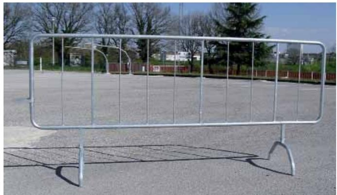
Fig. 2400 dimensioni 110x200 cm., tubolare  $\varnothing$  32 mm., con nr. 6 tondini  $\varnothing$  8 mm., nr. 3 tubolari quadri 15x15 mm., per eventuale applicazione pannello rifrangente b/r cl.1 20x150 cm.
